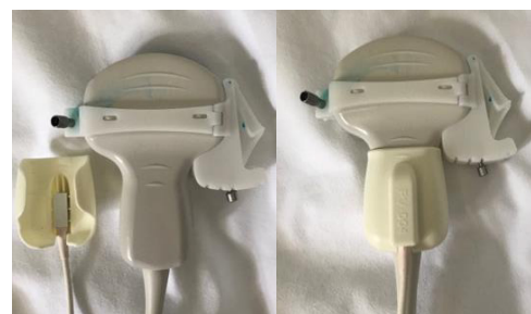
Изображение 2 Магнитный сенсор закреплён на ультразвуковом датчике
